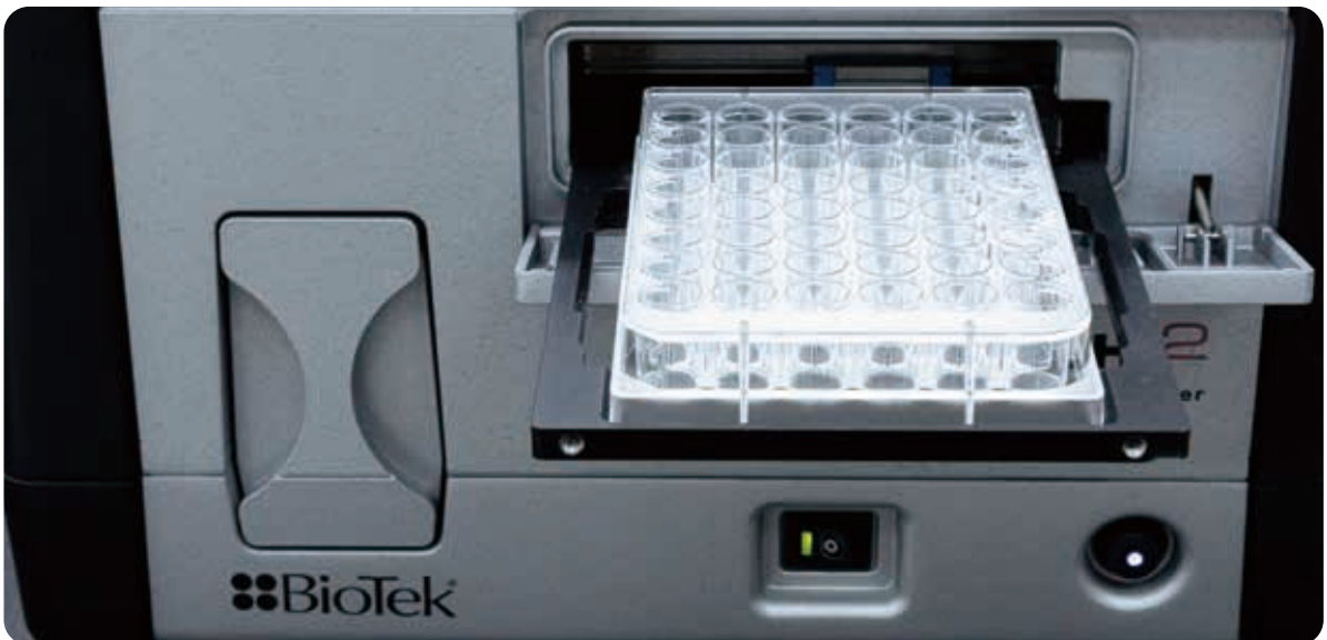
▲ [그림 1-7] 마이크로플레이트 리더를 이용한 흡광도 측정
