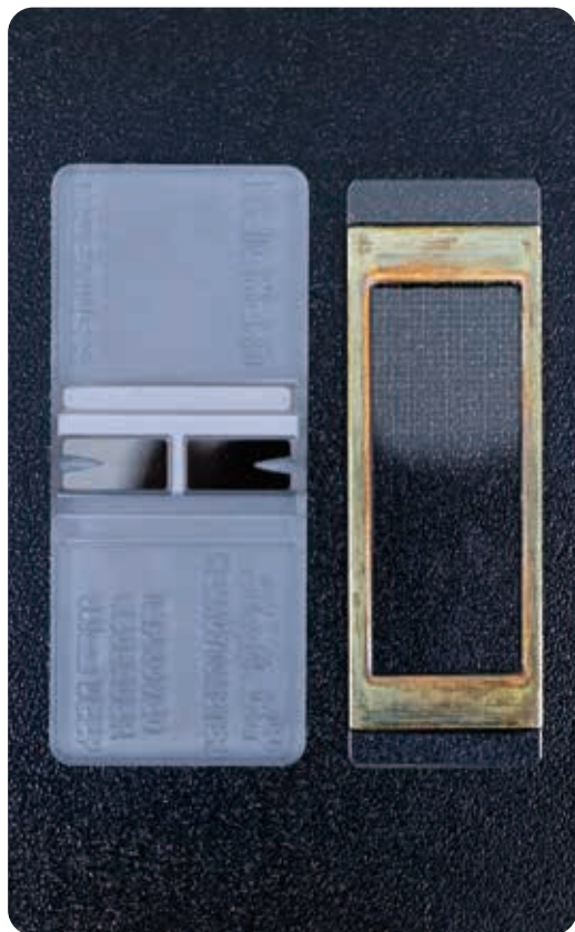
▲ [그림 1-5] (좌) 혈구계수기, 세즈웁 라프트 챔버, (우) 광학현미경을 이용한 세포수 측정
