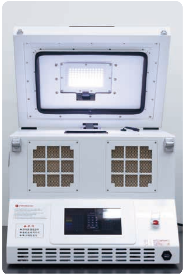
▲ [그림 1-4] (좌상) 광생물반응기에 사용되는 세포 배양판, (좌하) 광생물반응기 배양조건, (우) 광생물반응기
