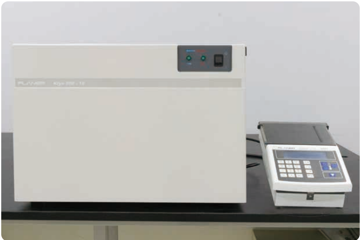
▲ [그림 2-2] 냉각 속도 제어 동결기(controlled rate freezer, CRF)
