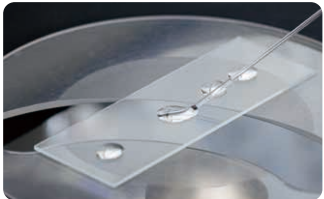
▲ [그림 1-1] 미세 유리관을 이용한 미세조류 단종 분리 수행 과정
