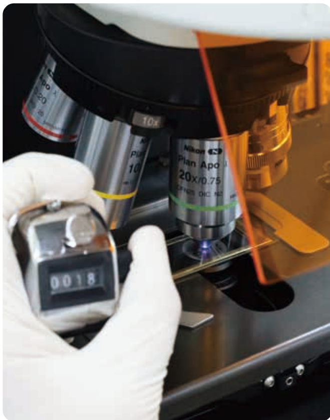
▲ [그림 1-5] (좌) 혈구계수기, 세즈웁 라프트 챔버, (우) 광학현미경을 이용한 세포수 측정
