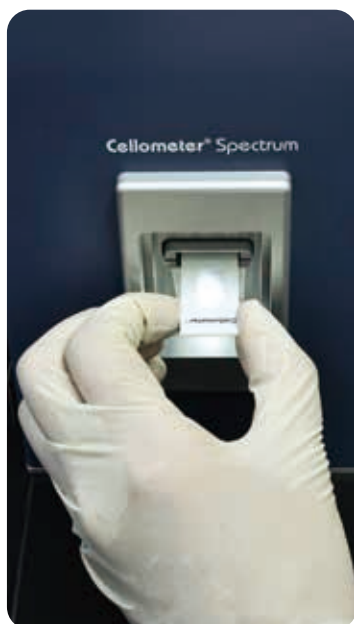
▲ [그림 1-6] 자동 세포계수기를 이용한 세포수 측정
