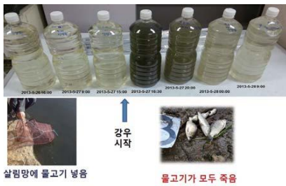
서울의 도시하천에서 강우 시 물의 색 변화와 어류 생존 가능성 실험. 강우 직후 검은색 흐린 물이 유출되고 살림망에 넣어 둔 물고기가 모두
